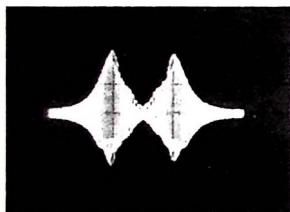
Bild 5. Messung des Frequenzhubs mit 1-MHz-Quarzspektrum (Trägerfrequenz 33,5 MHz, Hub etwa \pm 12 \text{ kHz} )
